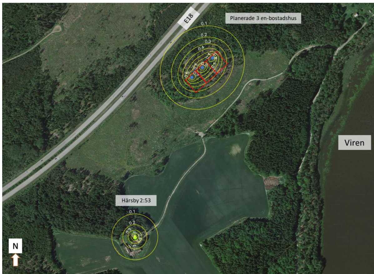
Figur 3. Influensområde tagits från AQTESOLV med ett vattenuttag på 1,7 m 3 /dygn. Varje ISO-linje står för 0,1 meter grundvattenavsänkning. De blå punkterna motsvarar lägena på de tre nya brunnarna och den gröna droppen motsvarar närmsta belägna brunn.
