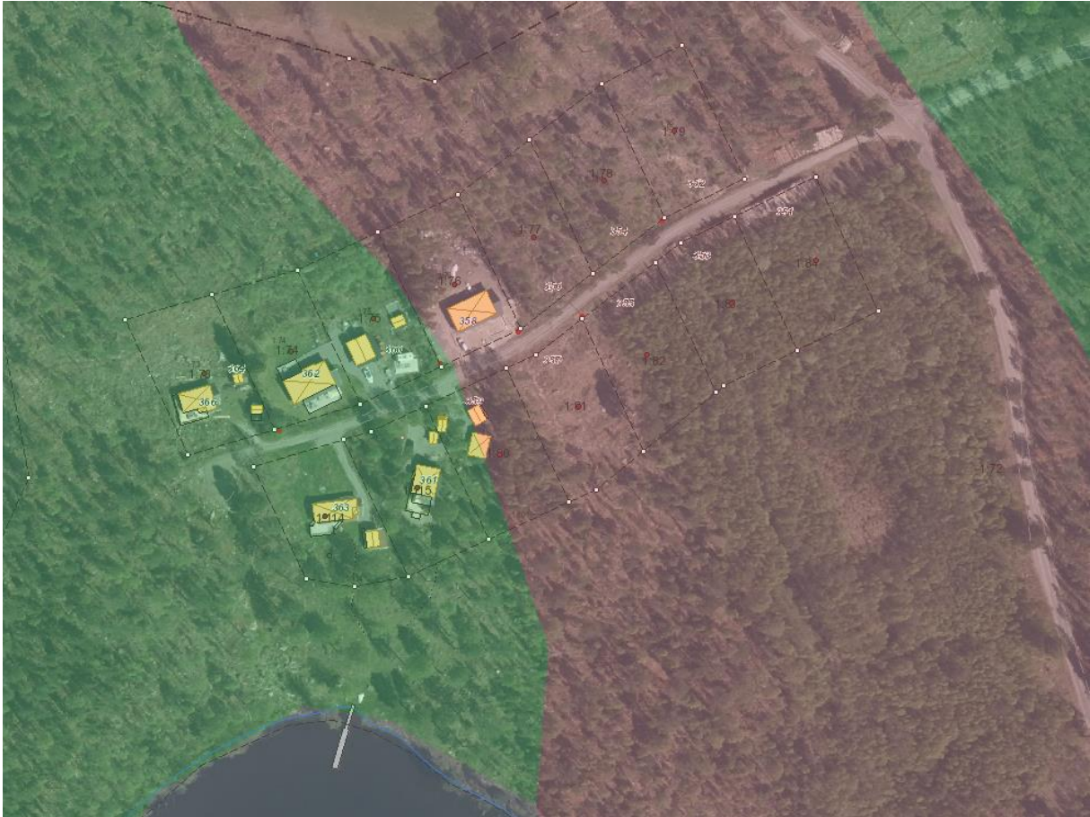
Figur 2. Utdrag ur kartsiktet Fastmark från SGU. Grön färg avser fast mark, röd färg ej fast mark.
