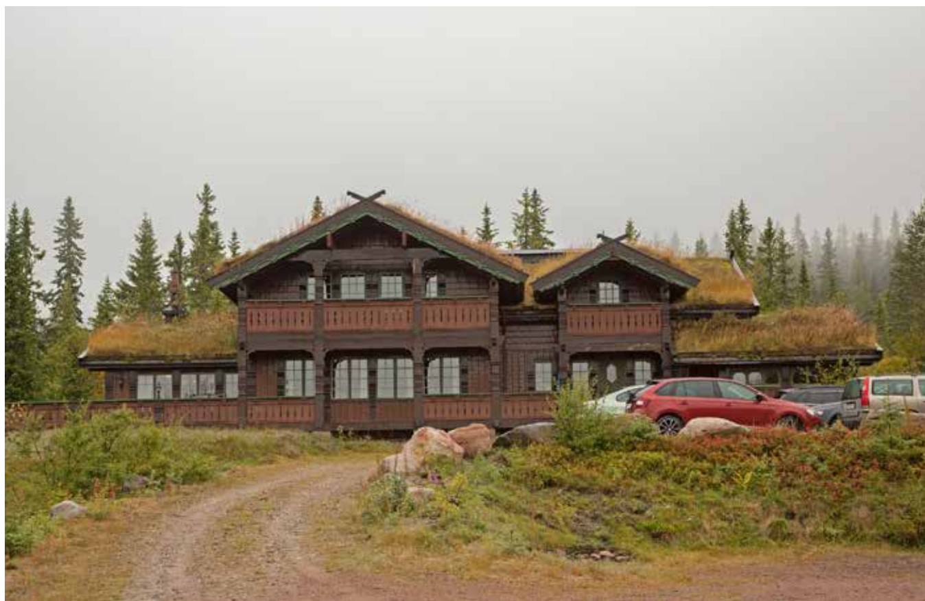
Stora byggnader delas upp i flera volymer och ger ett spännande uttryck. Användandet av grovt trä varieras i stående och liggande. Fönstersättningen symmetrisk och uppdelad med spröjsade rektangulära fönster med glasyltor på högkant. Foto från Trysil.
